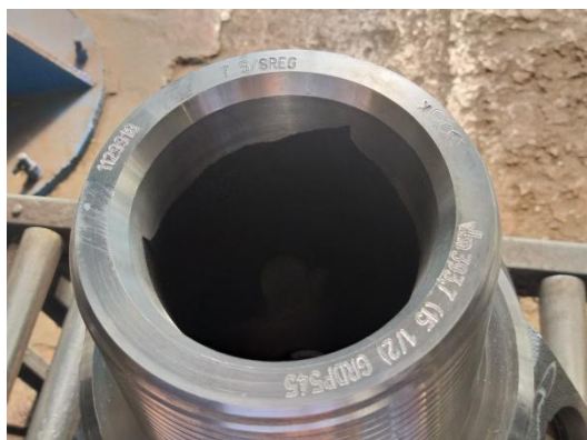
Вид на торец ниппеля (маркировка долота)
